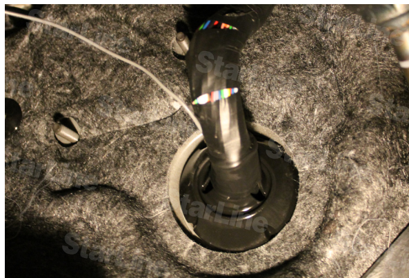
Фото 4.4. Штатный уплотнитель (вид из салона)
