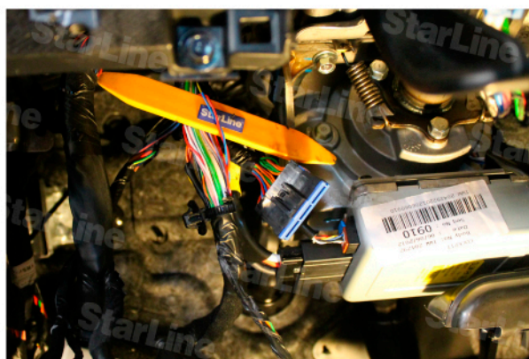
Фото 7.3. Провода CAN-шины (жгут с тыловой стороны блока предохранителей)
