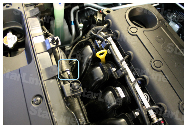
Фото 4.2. Датчик температуры
